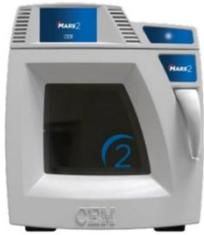
**工作原理:** 微波消解仪的工作原理主要基于微波与样品的相互作用, 以及消解过程中温度和压力的提高, 利用微波辐射的高能量, 使样品中的分子(主要是极性分子)快速振动, 产生剧烈的摩擦和碰撞, 从而将样品分解为原子或离子状态。在微波消解过程中, 密闭的消解罐内压力增加, 反应温度提高, 从而大大提高了反应速率, 缩短了样品制备的时间。此外, 微波消解仪通常采用酸等试剂与样品共同加热, 以促进样品的分解和反应。
